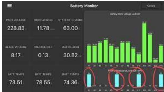
Şəkil 3. Hibrid batareyanın diaqnostika aləti
