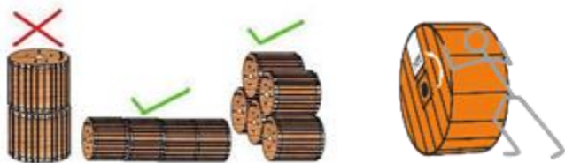
Şəkil 16. İş sahəsinə gətirilən optik kabelin barabanı.
