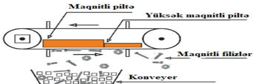
Şəkil 4.2.1. 171A-CƏ markalı separatorun görünüşü və iş prinsipi
