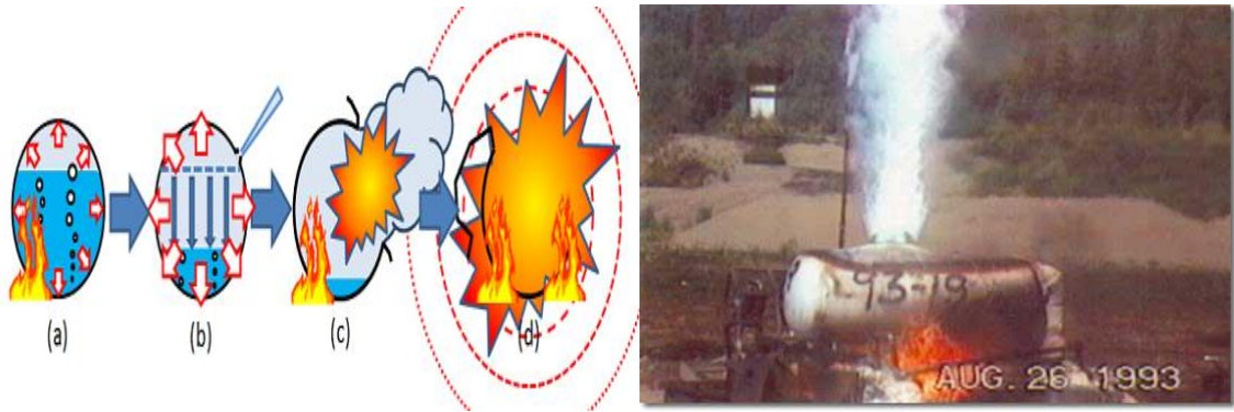
Şəkil 4.2. Qaynar-Maye Genişlənən-Buxar Partlaması
