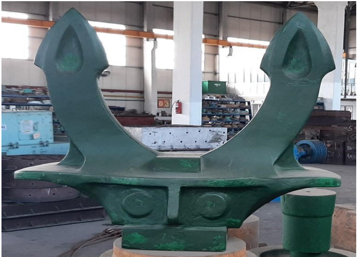
Şək.3.13. Metal tullantılardan alınmış Holl gəmi lövbəri, 600 kq
