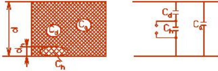
Şəkl.4.2.1. Dielektrikdə qismi boşalmaların hesabatlarına aid sxemlər
