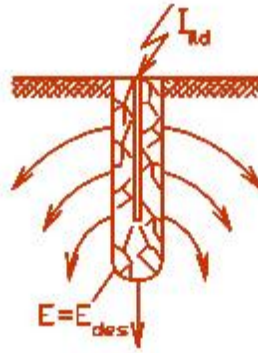
Şək.8.1.1 Şaquli elektrodun ətrafında, torpağın dərinliyində yaranan qığılcımlı zona
