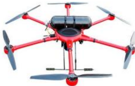
Şəkil 2.4. MMCs HyDrone 1550 multikopter 1800W H1-Fuel Cell ilə təchiz edilmişdir (Mohamed Nadir Boukoberinea , Zhibin Zhoub , Mohamed Benbouzid, 2019)
