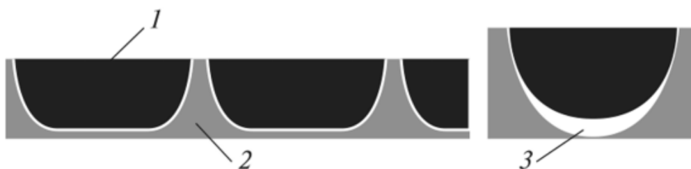
Şəkil 2.5. Aniloks valın hücrələrinin boya ilə normal doldurulması (solda) və böyük hücrə dərinliyində boyanın qurudulması (sağda):
