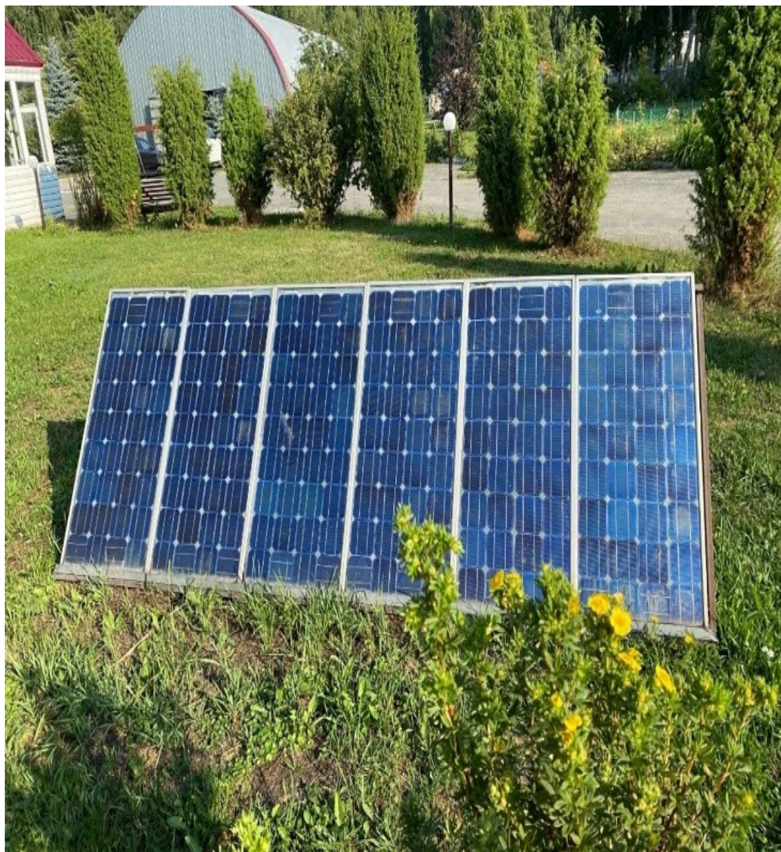
Şəkil 2.8. Monokristal silisium əsasında 150 Vt gücündə fotoelektrik çevirici
