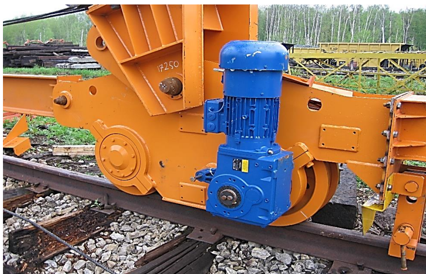
Şək. 3.3. "Bonfiglioli" (İtaliya) konik silindrik dişli mühərrikdən çatılı kranın hərəkət mexanizminin idarə edilməsi (Sobhan Sarkar & J. Maiti 2017)
