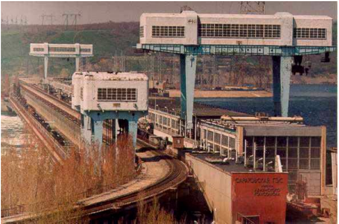
Şək. 1.5. Hidro elektrik stansiyalarında istifadə olunan K2×180/50+10 markalı çatılı kran (sağda). (Magdeburg, 2011)
