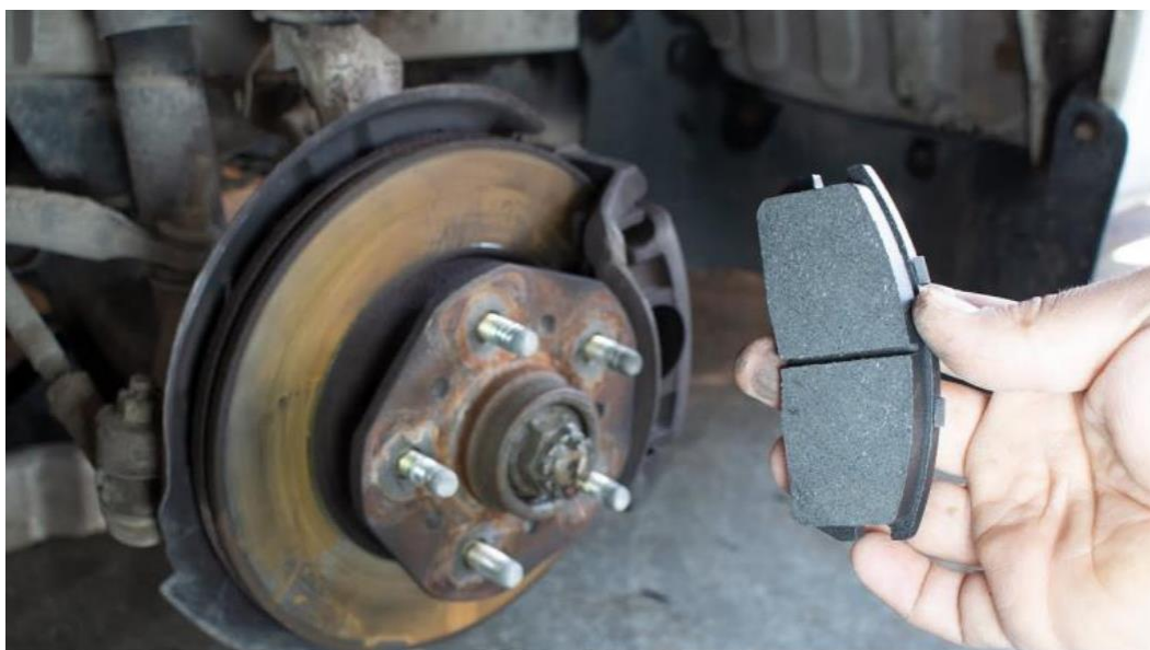
Şək 1.15 Əyləc diski, kalibr və əyləc qəlibi.
