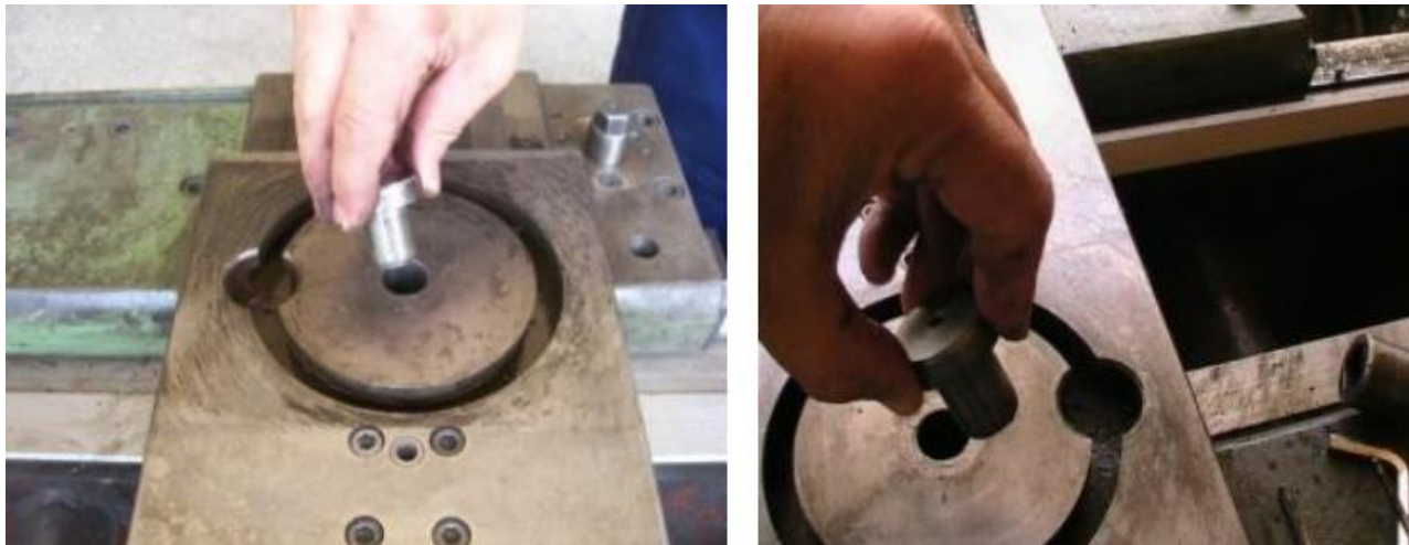
Şək.2.10. Silindrik başlıq parçanın yenisi ilə əvəz edilməsi
