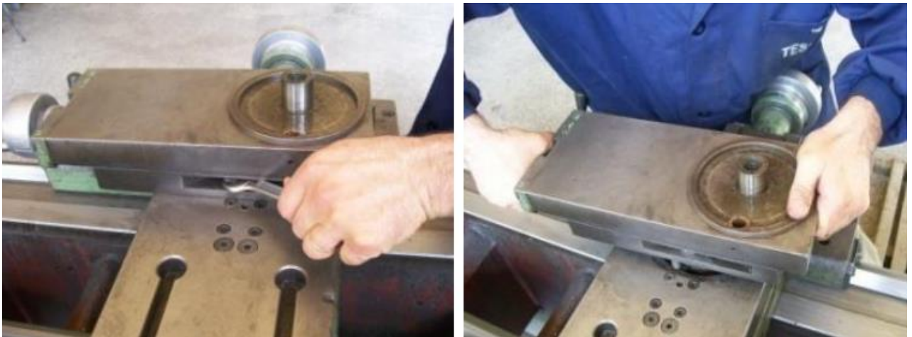
Şək. 2.8.Dəstəyin əsas hissənin çıxarılması
