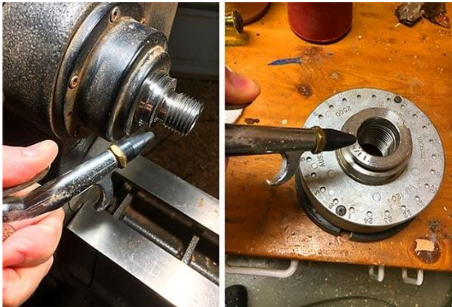
Şək. 3.3. CU 500 dəzgahında müşahidə elədiyimiz əskik yağlanma
