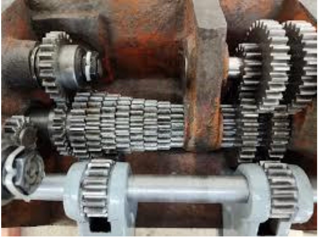
Şək. 3.2.. CU 500 torna dəzgahında vibrasiya müşahidə edilən nasazlıq
