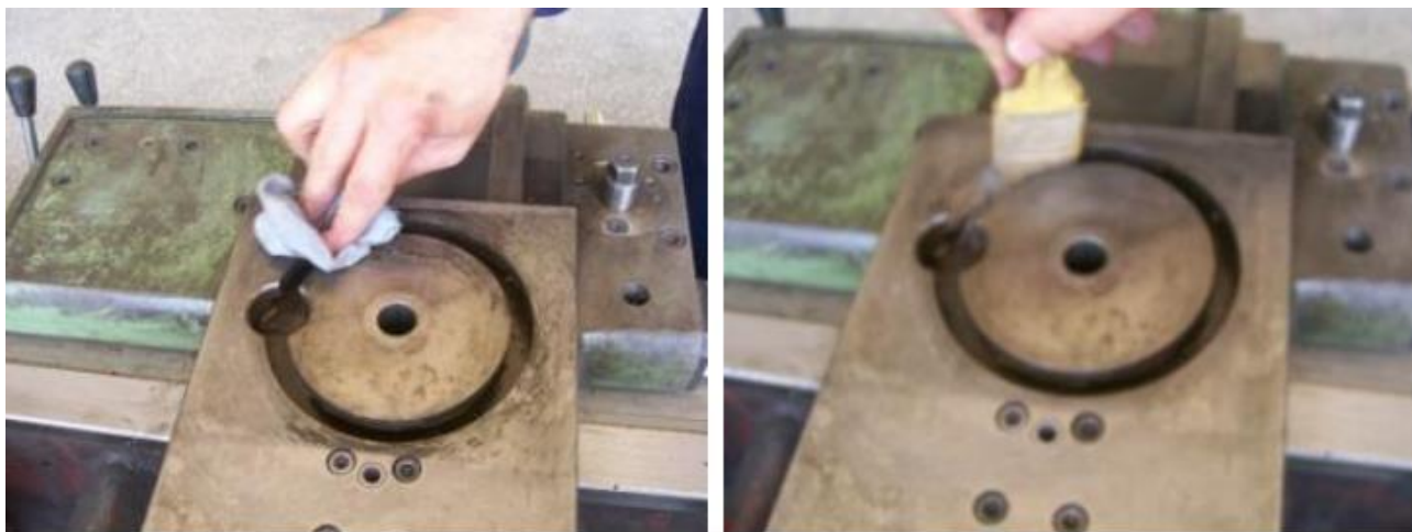
Şək. 2.11.Çıxarılan hissənin təmizlənməsi
