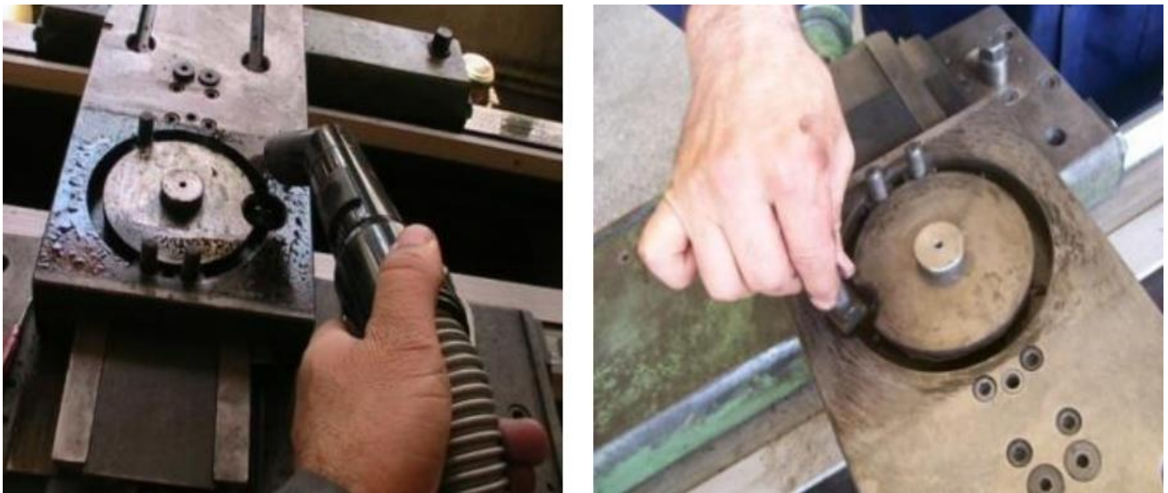
Şək. 2.9.Vintlərin təmizlənərək çıxarılması
