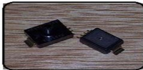
Şəkil 12. Silikon piezorestiv təzyiq sensoru
